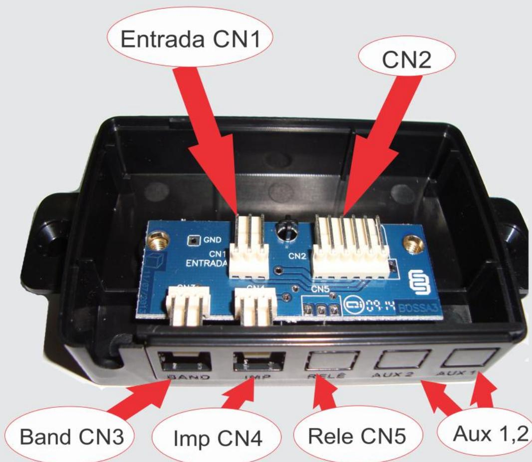
**Entrada Cn1:** É a entrada, alimentação, deverá ser conectado o chicote ou cabo sensor de roda
